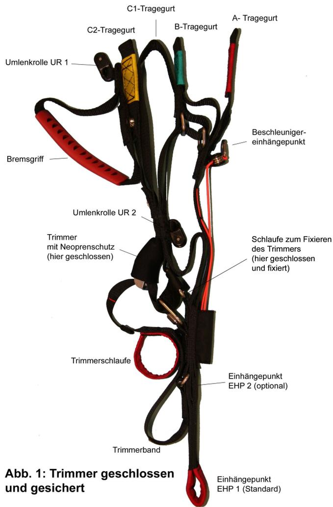
**Abb. 1: Trimmer geschlossen und gesichert**
